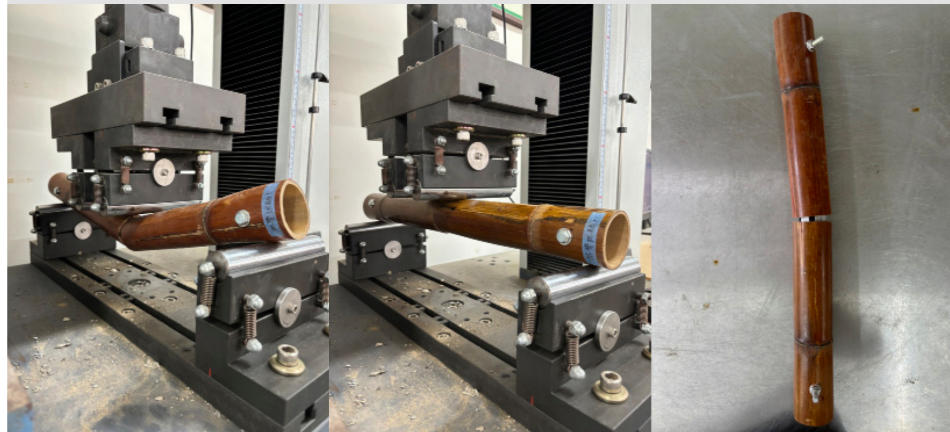
桂竹續接處鐵件補強抗彎試驗
